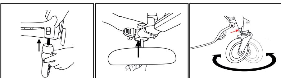
Koła skrętne: Wózek jest wyposażony w koła przednie, które mogą się swobodnie obracać lub mogą być zablokowane. Zalecamy stosowanie kół z blokadą na nierównych terenach. Swobodnie obracające się koła umożliwiają lepsze i łatwiejsze używanie wózka na drodze z równą powierzchnią. W celu zablokowania kólek, (aby się nie obracały) należy nacisnąć przycisk zabezpieczający, który jest umieszczony w górnej części przedniej konstrukcji nad każdym kółkiem (c).
