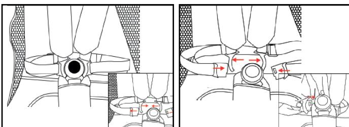
Chcete-li rozepnout břišní popruh, stiskněte tlačítka centrální přezky, čímž uvolníte všechny díly pásu. Samostatně je možné uvolnit jednotlivé části s tlačením přezky vlevo a vpravo.
