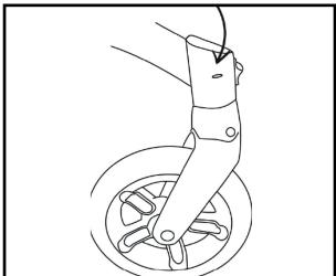
A hátsó kerék kioldásához nyomja meg a kerék belső oldalán lévő gombot.
