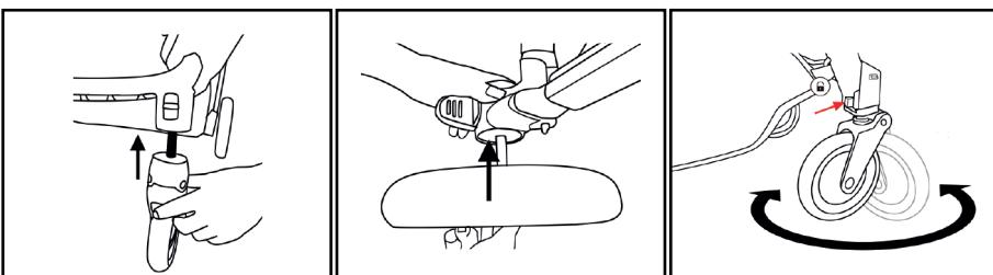
Kočík je vybavený prednými kolieskami, ktoré sa môžu buď voľne otáčať alebo zaistiť. Odporúčame používať zaistené kolieska na nerovných terénoch. Voľne otočné kolieska zase umožňujú lepšiu a ľahšiu manipuláciu s kočíkom na cestách s rovným povrchom. Na zaistenie (aretovanie) kolieska (proti otáčaniu) stlačte poistku, ktorá je umiestnená zhora nad každým kolieskom (c).
