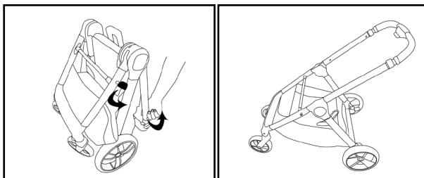
**3. Stiskněte tlačítko na rukojeti a vytáhněte směrem do výšky. Nastavte výšku rukojeti podle potřeby.**
