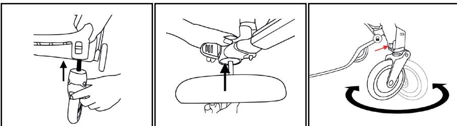
Kočárek je vybaven předními kolečky, která se mohou buď volně otáčet nebo zajistit. Doporučujeme používat zajistěná kolečka na nerovných površích. Volně otočná kolečka zase umožňují lepší a snadnější manipulaci s kočárkem na cestách s rovným povrchem. Na zajištění (Aretace) kolečka (proti otáčení) stiskněte pojistku, která je umístěna shora nad každým kolečkem (c).
