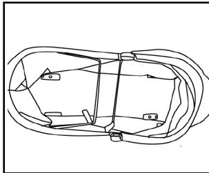
2. Potiahnite za popruhy umiestnené na kovových výstužiach vaničky tak aby ste výstuž umiestnili do pripraveného ukotvenia. Tým vaničku rozložíte.
