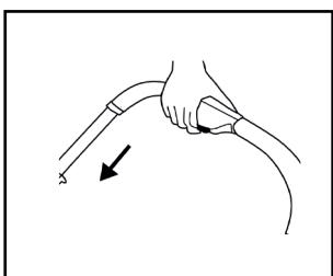
4. Naciśnij przyciski zabezpieczające (a) po obu stronach rękojeści, jednocześnie ciągnąc za dodatkową blokadę (b) po obu stronach rękojeści.
